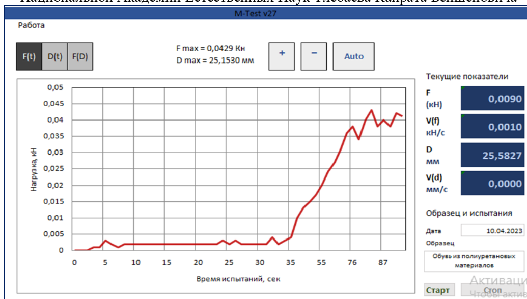
Сурет 1. Полиуретанды аяқ-киімнің икемділігіне жүргізілген сынақтың Mtest компьютерлік бағдарламасы арқылы алынған нәтижесі
